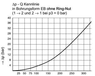
Die  $\Delta p$  Kennlinie ist gültig wenn in der Verbindung  $1 \to 2/2 \to 1$  ein Lastdruck grösser als der Öffnungsdruck vorhanden ist. Bei einem Lastdruck kleiner als der Öffnungsdruck muss beachtet werden, dass der Öffnungsdruck immer zuerst überwunden werden muss.
