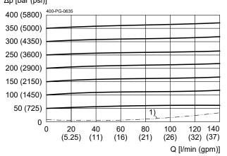
Druckeinstellung Typ N / pressure range type N  $p_N$  = 350 bar (5000 psi) 1) Einsatzgrenze / Application limit
