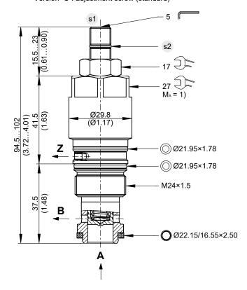
Version "H": Einstellschraube mit Handrad Version "H": adjustment screw with handknob
