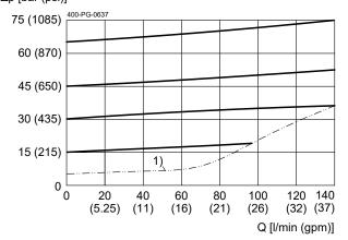
Druckeinstellung Typ L / pressure range type L  $p_N$  = 65 bar (940 psi) 1) Einsatzgrenze / Application limit
