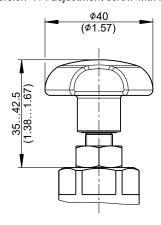
Einstellschraube mit Sicherungskappe adjustment screw with tamper-proof cap
