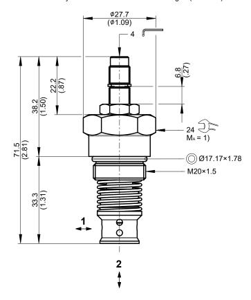
Version "H": Einstellschraube mit Handrad Version "H": adjustment screw with handknob
